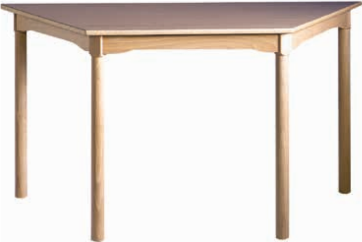
HPL-Schichtstoffplatte Gütespanplatte 19 mm stark, Tischkante Kunststoffbeschichtung mit 2 mm ABS-Anleimer. Holzdekor nach Kundenwunsch.
