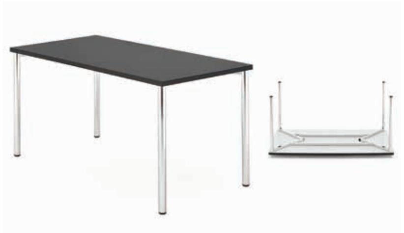
Tisch mit Stahlgestell pulverbeschichtet, ohne Zargenrahmen. Rundprofil. Standardtischhöhe 74 cm, Tischplatte 30 mm HPL mit ABS Kante. Gestell verchromt (gegen Aufpreis erhältlich)
