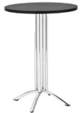
**Modell 3038:** Mittelsäulentisch, Stahlrohrgestell aus Rundstahlrohr Ø 30 x 2,0 mm, Ausleger Ø 35 x 2,0 mm, verchromt oder pulverbeschichtet.
